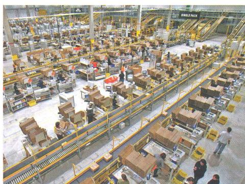
методом «волны» определяет, какие заказы размещаются в каждой волне, независимо от способа их погрузки. Укомплектованные заказы, как правило, помещают на конвейер и транспортируют к системе сортировки для конечной комплектации и добавления некоторых необходимых атрибутов (промовложения, документы и т.д.).
